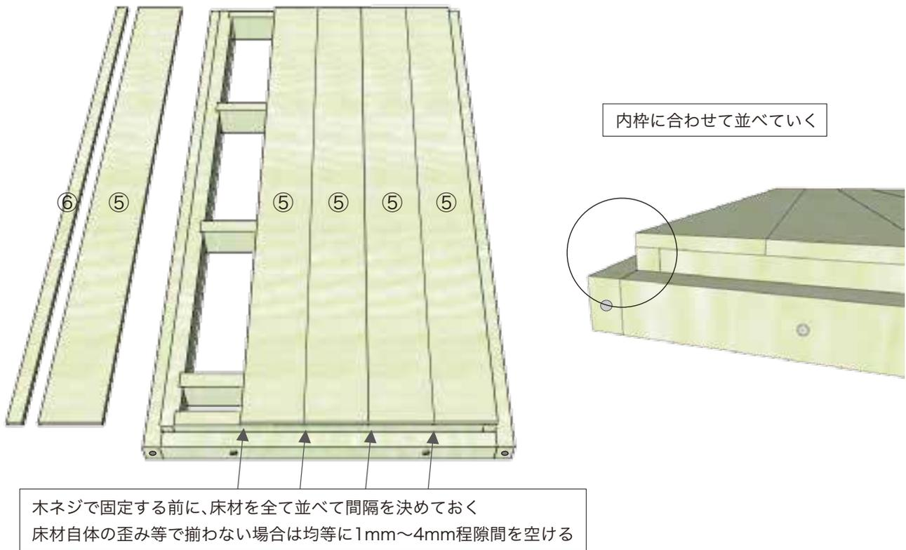
**8** 38mm木ネジで床板を全て固定します。(床材にあらかじめ下穴を開けておくと綺麗に仕上がります。)
