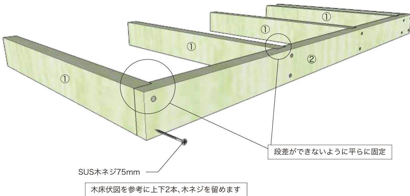
3 全て固定すると四角い内枠組みが完成します。
