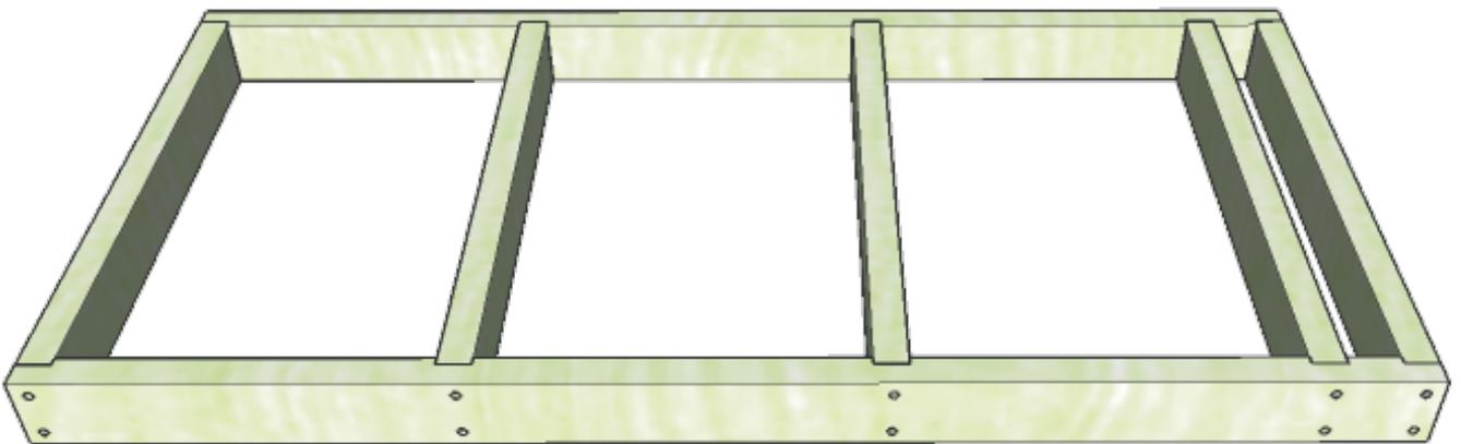
4 完成した内枠組と外枠の下を合わせるように置きます。
